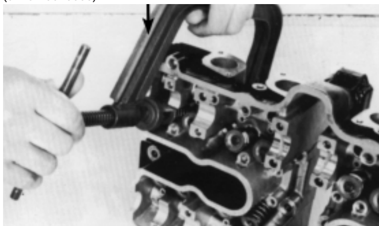
COMPRESSOR DA MOLA DA VÁLVULA (07757-0010000)
